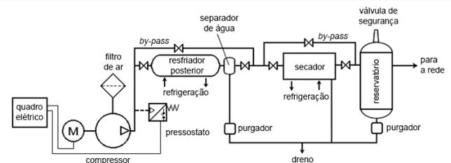
Considerando a figura acima, que representa o esquema de uma instalação de ar comprimido destinada à aplicação, na qual são exigidas pressões relativamente baixas e vazões muito grandes, julgue os itens seguintes.
