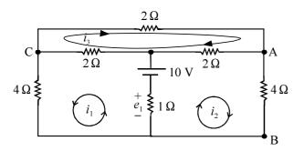
Considerando que, no circuito elétrico mostrado na figura acima, todas as resistências estejam em ohms e as grandezas  $i_1$ ,  $i_2$  e  $i_3$  representem correntes de malha orientadas conforme os *loops* mostrados no circuito, julgue os itens que se seguem.
