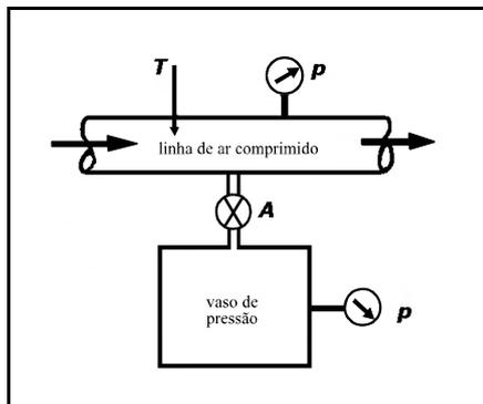
A figura acima mostra um sistema fechado, isolado termicamente, consistindo de uma linha de ar comprimido e de um vaso de pressão, inicialmente vazio, conectado à linha pela válvula *A*, que encontra-se fechada. Considere que, no sistema original, o ar estava à temperatura  $T_1$  e que, após a abertura da válvula, o ar passa a ter temperatura  $T_2$ . Nessas condições, julgue os itens seguintes.
