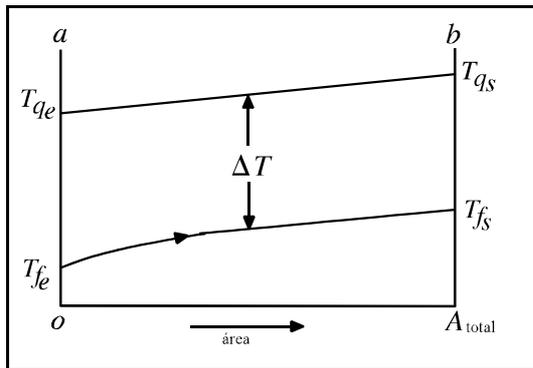
A figura acima mostra a variação de temperatura em dois fluidos ao longo de um trocador de calor simples do tipo tubo-e-carcaça concêntricos.  $T_{fe}$  e  $T_{qe}$  são as temperaturas de entrada dos fluidos frio e quente, respectivamente, e  $T_{fs}$  e  $T_{qs}$  são, analogamente, as temperaturas de saída dos fluidos frio e quente. A situação esquematizada
