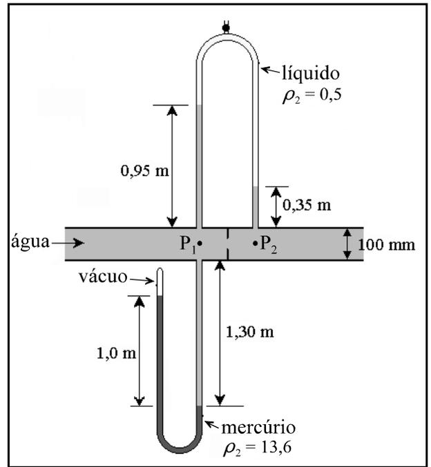
Um manômetro de tubo em U fechado, contendo mercúrio ( $\rho_r = 13,6$ ), está instalado na parte inferior de uma tubulação de água, conforme mostrado na figura acima. No ponto  $P_1$ , diretamente acima da tomada de pressão, está montado um outro manômetro de tubo em U invertido, que contém um líquido de densidade relativa  $\rho_r = 0,5$ . Nessa situação, considerando os dados apresentados na figura, a pressão em  $P_2$  será igual a
