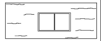
119 O padrão de fissuras esquematizado na viga desenhada na figura abaixo pode ser resultante de armadura insuficiente para combater o cisalhamento.
