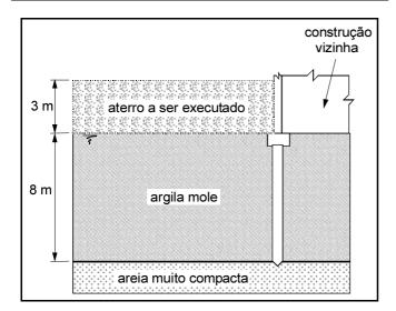
A figura acima apresenta um aterro que deverá ser executado rapidamente ao lado de um prédio existente. Os elementos de fundação dos pilares de divisa do prédio são estacas com pontas apoiadas na camada de areia resistente subjacente à camada de argila mole saturada (nível d'água superficial). Com relação à situação apresentada, julgue os itens subsequentes.
