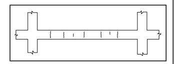
**120** O padrão de fissuras esquematizado na construção ilustrada na figura abaixo pode ser resultante do ataque da argamassa de revestimento por sulfatos.
