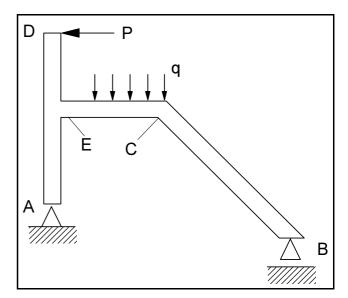
Acerca da figura acima, que apresenta um pórtico plano submetido a uma carga concentrada P e a um carregamento uniformemente distribuído com intensidade q, julgue os itens seguintes, desprezando o peso do pórtico.
