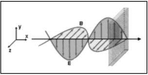
Propagação de uma onda eletromagnética
