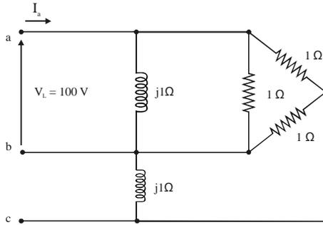
Um circuito elétrico era formado, inicialmente, por duas cargas equilibradas, ambas ligadas em triângulo. Uma das fases da carga indutiva rompeu-se, resultando no circuito elétrico ilustrado na figura acima. Sabendo que  $\cos(30^\circ) = \frac{\sqrt{3}}{2}$  e que  $\sen(30^\circ) = \frac{1}{2}$  e
