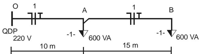
O circuito terminal indicado no esquema unifilar apresentado na figura acima tem as cargas distribuídas a 10 m e a 25 m do quadro de distribuição principal. Os condutores do circuito ficam dispostos em eletroduto de PVC embutido em alvenaria. Considerando que a tensão nominal da rede elétrica aplicada ao circuito seja igual a 220 V, julgue os itens a seguir.
