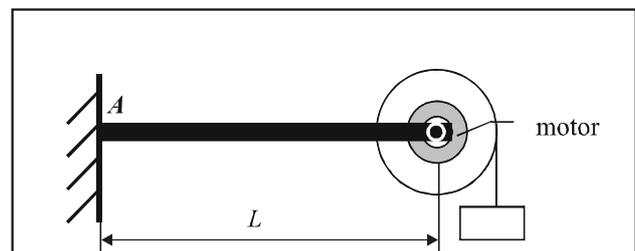
Um elevador é suspenso por um tambor de raio  $R$ , o qual é acionado por um motor de peso  $P_1$  fixado na extremidade de uma viga, conforme apresentado esquematicamente na figura acima. Considerando  $P_2$  a carga sustentada pelo cabo do elevador, e desprezando o peso próprio da viga e o atrito, julgue os itens que se seguem.
