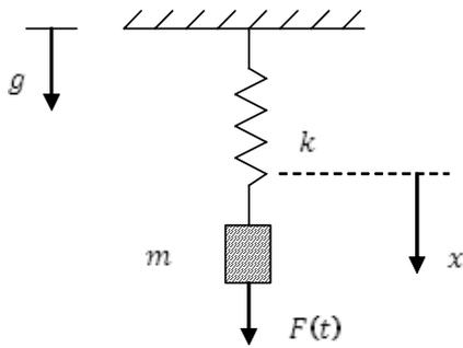
A figura acima ilustra um sistema massa-mola em que  $g$  é a aceleração da gravidade, a mola é linear, de constante elástica  $k$  tal que a força elástica exercida sobre a massa  $m$  é proporcional ao deslocamento na direção  $x$ . É imposta ao sistema uma força externa expressa pela relação  $F(t) = F_0 \text{sen}(\omega t)$ . A linha tracejada marca a posição de repouso do sistema, na ausência da força. Com base nas informações apresentadas na figura, julgue os itens a seguir.
