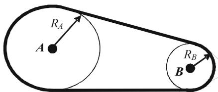
A figura acima ilustra a transmissão por correia entre as polias de centros em  $A$  e em  $B$ , em que  $R_A > R_B$ . Sendo  $T_A$  o torque e  $\omega_A$  a velocidade angular da polia de centro em  $A$ ; e  $T_B$  o torque e  $\omega_B$  a velocidade angular da polia de centro em  $B$ , julgue os itens de 76 a 79.
