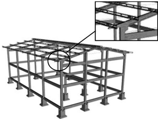
Figura II: Esqueleto estrutural em concreto e aço
