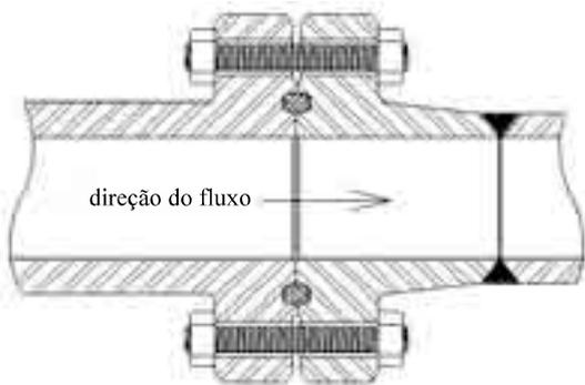
Vários tipos de flanges são utilizados nos acoplamentos entre tubulações industriais e entre estas e equipamentos, como bombas, compressores, tanques, vasos etc. Na junção esquematizada na figura acima,
