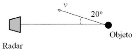
Um objeto móvel dotado de velocidade linear constante  $v$  adentra ao campo de detecção de um radar Doppler estacionário, situado em um meio de índice de refração igual a 1,02, conforme o esquema acima. O radar emite ondas eletromagnéticas a 10 GHz, que detectam a aproximação do objeto, segundo um ângulo de 20 graus.
