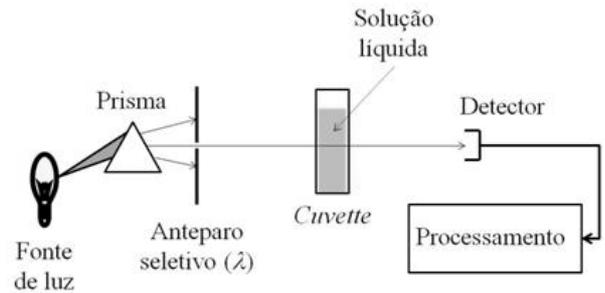
Em um experimento de espectrofotometria, ilustrado na figura acima, a solução líquida depositada em uma *cuvette* (também chamada de cubeta) é submetida à análise de luz monocromática de comprimento de onda correspondente a sua máxima absorvância. Após percorrer um caminho de 2 cm dentro da solução depositada na *cuvette*, a intensidade da luz transmitida é 100 vezes inferior à intensidade da luz incidente.
