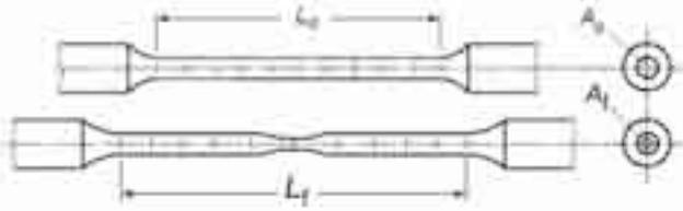
Em um ensaio de tração, realizado no corpo de prova de aço mostrado na figura acima, foram observadas as seguintes leituras:
