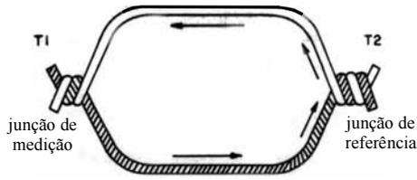
Um termopar é constituído de dois metais distintos, tais como ferro e constantan, que são unidos para produzir uma diferença de potencial quando as junções apresentam diferentes temperaturas. Com relação aos termopares, assinale a opção **incorreta**.
