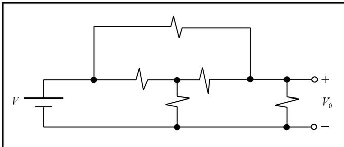
O circuito acima mostra uma rede resistiva alimentada por uma fonte DC. Considerando que todas as resistências do circuito são iguais a  $1\Omega$ , assinale a opção que descreve a relação entre a tensão de saída e a tensão de entrada.
