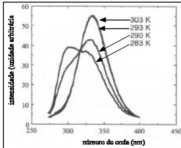
Para estudar a dependência de uma amostra de poliestireno isotático (iPS) gel com relação à temperatura, foram obtidos os espectros de fluorescência apresentados na figura acima, com excitação em 275 nm. Acerca dessa situação, julgue os seguintes itens.
