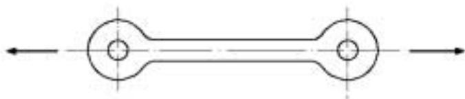
Considere que a barra mostrada na figura acima seja parte de um mecanismo articulado de um sistema robótico e tenha como função a transmissão de movimento linear e forças por meio de pinos transversais montados nos olhais. Com relação aos critérios de seleção do material para essa aplicação, julgue os itens subsequentes.
