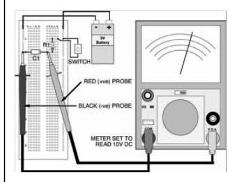
**72** A figura a seguir corresponde a uma operação de medição de tensão através do resistor.
