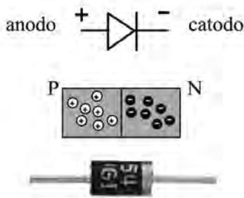
O diodo semicondutor é um componente eletrônico que tem duas polaridades: anodo (terminal positivo) e catodo (terminal negativo), formando uma junção *p-n*, como ilustrado na figura acima. O diodo semicondutor é chamado retificador, pois permite a passagem de corrente elétrica apenas quando está conectado no circuito na forma denominada direta; ou, de maneira mais simplificada, funciona como se fosse uma válvula que só deixa a corrente passar pelo circuito em um sentido.
