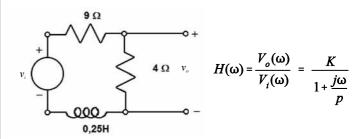
Considere que o circuito elétrico acima seja alimentado por uma fonte de tensão  $v_i(t)$  (sinal de entrada) e que se deseje observar o sinal de saída  $v_0(t)$  nos terminais do resistor de 4  $\Omega$ . Com base nessas informações e considerando, ainda, que  $\omega$  é a frequência angular, em rad/s, e  $H(\omega)$  é a razão, em frequência, entre os sinais de saída e entrada mencionados, conforme a equação acima, julgue os itens seguintes.
