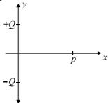
112 Considerando que a figura abaixo representa uma onda eletromagnética TEM em um meio sem perdas, homogêneo, isotrópico e linear, é correto afirmar que essa onda está se propagando na direção do eixo x, no sentido negativo.
