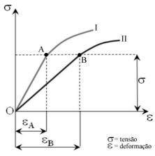
No concreto armado, o concreto resiste melhor aos esforços de compressão, enquanto o aço, aos esforços de tração. Considerando essa afirmação e com base no gráfico tensão × deformação acima, julgue os itens que se seguem, relativos ao aço.
