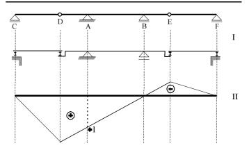
As figuras acima representam uma estrutura isostática (figura I) e os resultados de um estudo de cargas móveis realizado sobre essa estrutura (figura II). Com base nas informações apresentadas nessas figuras, julgue os itens subseqüentes.
