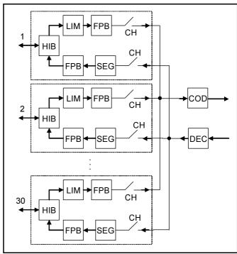
HIB – junção híbrida; LIM – limitador; FPB – filtro passa-baixas; SEG – segurador de tensões (*sample and hold*); CH – chave de amostragem; COD – codificador PCM; DEC – decodificador.
