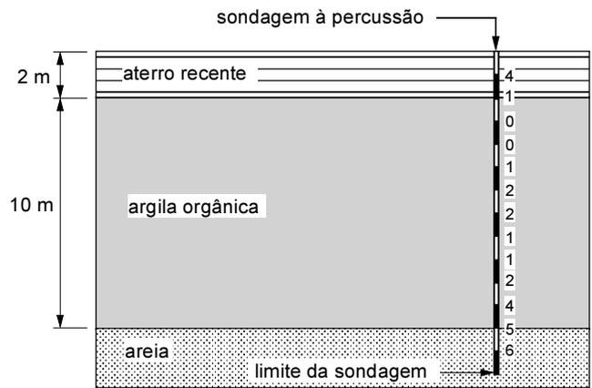
Considere o perfil do subsolo apresentado no desenho acima. Em cima do aterro recém executado sobre a camada de argila orgânica saturada, pretende-se construir um prédio residencial com 10 pavimentos, com área em planta de 180 m<sup>2</sup>. O desenho apresenta também resultados obtidos em uma sondagem à percussão realizada no local, que foi interrompida a 12 m de profundidade por solicitação do cliente. Com base nessa situação, julgue os itens subseqüentes.
