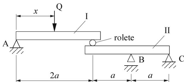
A figura acima corresponde ao desenho de uma estrutura plana, rígida e com peso desprezível, que se encontra em equilíbrio. A carga concentrada  $Q$  (não-nula) atua a uma distância  $x$  do apoio A. Com base nessas informações, julgue os próximos itens.
