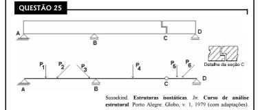
A figura acima representa, esquematicamente, uma viga e o carregamento atuante sobre ela. Assinale a opção correta acerca das características e do funcionamento dessa viga.
