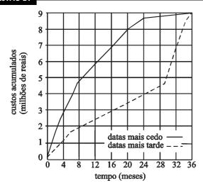
No planejamento e na elaboração do orçamento de uma obra com condicionantes apenas tecnológicos, utilizando-se as técnicas PERT e CPM, foi construído o gráfico mostrado acima. Nele estão representados os custos acumulados para duas programações diferentes (com base nas datas mais cedo e datas mais tarde). Considerando essas informações, assinale a opção correta.
