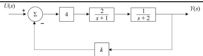
Considerando um processo físico que é modelado por meio do diagrama em blocos mostrado na figura acima, em que o sinal de entrada é  $U(s)$ , o de saída,  $Y(s)$ , e  $s$  é o operador da transformada de Laplace, e em que tanto o sinal de entrada quanto o de saída são sinais de tensão, julgue os itens que se seguem.
