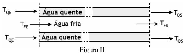
Um trocador de calor é composto por dois tubos concêntricos muito longos. Considere dois modos de operação para o trocador: I) contracorrente e II) correntes paralelas ilustrados respectivamente nas figuras acima. As temperaturas de entrada da água quente e fria são, respectivamente,  $T_{QE} = 85\text{ }^{\circ}\text{C}$  e  $T_{FE} = 15\text{ }^{\circ}\text{C}$ . A vazão de água quente é o dobro da de água fria. Considere que os valores do calor específico para a água quente e fria são iguais.
