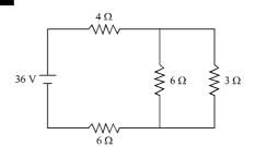
A corrente que passa no resistor de 3  $\Omega$  do circuito ilustrado acima é igual a
