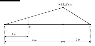
A figura acima representa o diagrama dos momentos fletores de uma viga biapoiada nos pontos de apoio A e B. Desprezando-se o peso próprio da viga, assinale a opção correta.
