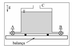
Um recipiente equipado com duas válvulas — A e B — e uma abertura de entrada — C — é montado sobre uma balança conforme ilustrado pela figura. A massa do recipiente quando vazio é m e seu volume interno é V. Os diâmetros das saídas A e B são iguais a d e o diâmetro da entrada C é igual a D. O fluido que preenche o recipiente é a água. Considere, quando necessário, que o escoamento na entrada C é uniforme e vertical e nas saídas A e B, uniforme e horizontal.
