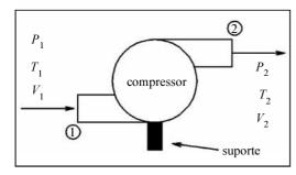
A figura acima ilustra um compressor que admite ar a velocidade, temperatura e pressão  $V_1$ ,  $T_1$  e  $P_1$  e o rejeita a velocidade, temperatura e pressão  $V_2$ ,  $T_2$  e  $P_2$ , respectivamente. Admitindo que o ar seja um gás ideal, assinale a opção correta com relação aos princípios de conservação da massa, do momento e da energia para um escoamento.
