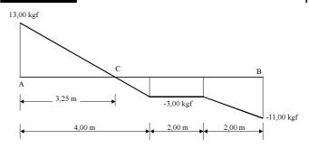
A figura acima representa o diagrama de esforços cortantes de uma viga biapoiada. Considerando que A e B são os pontos de apoio da viga e que seu peso é desprezível, assinale a opção correta.
