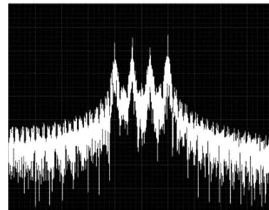
A figura acima mostra o espectro de um sinal digital modulado, observado em um analisador de espectro. O eixo horizontal do gráfico representa a frequência, e o eixo vertical representa a densidade espectral de potência relativa do sinal, em dB/Hz. Considerando essa figura, julgue os itens a seguir.
