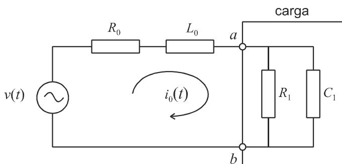
No circuito elétrico acima, a fonte de tensão senoidal  $v(t)$ , de frequência igual a 50 Hz e valor de pico 100 V, alimenta uma carga composta pela associação em paralelo de um resistor  $R_1 = 10\Omega$  e um capacitor  $C_1 = \pi^{-1} \text{ mF}$ . Entre a carga e a fonte, observa-se uma resistência  $R_0 = 5\Omega$  em série com uma indutância  $L_0$ . Considerando que esse circuito esteja funcionando em regime permanente, julgue os seguintes itens.
