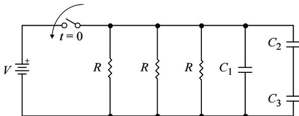
Considerando que o circuito ilustrado na figura acima seja alimentado por uma fonte contínua (c.c.) de valor nominal  $V$  e esteja fechado no instante  $t = 0$ , e que os capacitores desse circuito estejam inicialmente descarregados, julgue os itens que se seguem.
