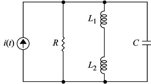
Considere que o circuito RLC paralelo ilustrado acima seja excitado por um gerador de corrente alternada (c.a.) cuja amplitude é dada pela expressão  $i(t) = I \cos(\omega t + \phi)$  [A], e que a frequência de operação ( $\omega$ ) desse gerador ajustável. Com base nessas informações, julgue os itens a seguir.
