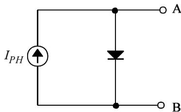
Um dispositivo fotovoltaico, submetido a iluminação constante, modelado de acordo com o circuito da figura acima, é constituído por uma fonte de corrente contínua ( $I_{PH}$ ) em paralelo com um diodo ideal. A carga ( $R_L$ ) será conectada aos pontos A e B. Considerando que a corrente de curto-circuito e a tensão de circuito aberto desse dispositivo sejam dadas por  $I_{SC}$  e  $V_{OC}$ , respectivamente, julgue os itens que se seguem.
