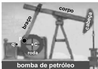
O desenho acima é um esquema simplificado de uma bomba de sucção de petróleo. O motor faz a roda girar, o que movimenta o braço de ligação entre a roda e o corpo da bomba. O braço está conectado à roda no ponto p. Nessa situação, considere que o movimento do ponto p ao longo da roda seja descrito pela função
