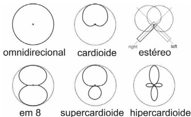
A figura acima ilustra a disposição de diagramas polares característicos de alguns microfones. As suas diversas combinações tornam possível controlar o processo de sonorização ou registro sonoro. Esse processo pode ser implementado mediante o uso dos princípios de construção, transdução e classificação quanto à directividade.
