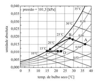
A figura acima representa uma carta psicrométrica para o ar úmido a uma dada pressão atmosférica padrão, em que estão indicados os processos de condicionamento de ar A-B, B-C e C-D. Com base nessas informações, julgue os itens que se seguem.
