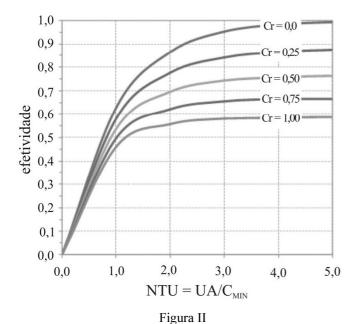
A figura I acima ilustra esquema de um trocador de calor (UA = 4 W/K), com suas condições operacionais indicadas. A figura II representa o gráfico da efetividade-NTU aplicável a esse trocador para razões de taxas de capacidade caloríficas ( $Cr = C_{MIN}/C_{MAX}$ ), variando de 0 a 1,00.
