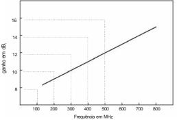
Os gráficos acima mostram o coeficiente de onda estacionária e o ganho (em  $dB_i$ ), em função da frequência, na direção de máxima radiação, de uma antena projetada para operar em espaço livre e ser alimentada por uma linha coaxial de 50 ohms. Considerando que essas informações sejam válidas tanto para transmissão quanto para recepção, julgue os próximos itens.
