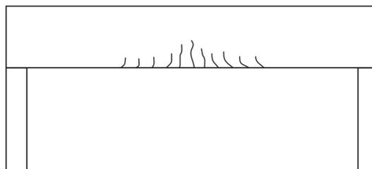
Um engenheiro civil foi designado para periciar um prédio que apresentava fissuras em uma viga de concreto biapoiada, conforme figura precedente. Ao vistoriar o local, ele constatou que havia uma flecha excessiva na viga e que as fissuras se propagavam também para a parede de alvenaria, construída acima da viga. No diário de obras sobre a execução da peça, encontrou a informação de que o escoramento da viga fora retirado cinco dias após a concretagem.
