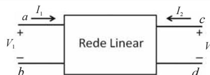
Um circuito linear é modelado por um quadripolo, como mostrado na figura acima, com os seguintes parâmetros de impedância:  $z_{11} = 10 \Omega$ ,  $z_{12} = z_{21} = 5 \Omega$  e  $z_{22} = 4 \Omega$ . Com base nessas informações, julgue os itens seguintes.
