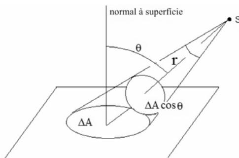
Dada a figura acima, considerando-se que o elemento de área  $\Delta A$  faz um ângulo  $\theta$  com a direção média dos raios luminosos emitidos por uma fonte pontual  $S$  de intensidade luminosa  $J$ , então o iluminamento em  $\Delta A$  será  $E = \frac{J \cos \theta}{r^2}$ .
