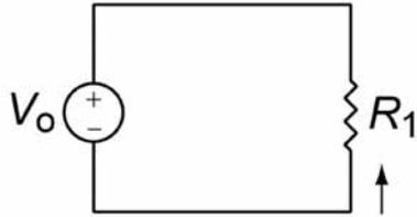
Considere, ainda, que a corrente que atravessa o resistor é constante e que a resistência do resistor é de 10 k $\Omega$ . Nesse caso, a tensão  $V_0$  é de
