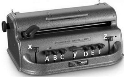
A máquina de datilografia braille (Perkins) apresenta em sua composição básica a sequência de 9 teclas. A tecla da esquerda foi nomeada de X, a central de Y e a última da direita de Z; já as teclas que grafam os pontos braille foram nomeadas da esquerda para direita como A, B, C, D, E e F.
