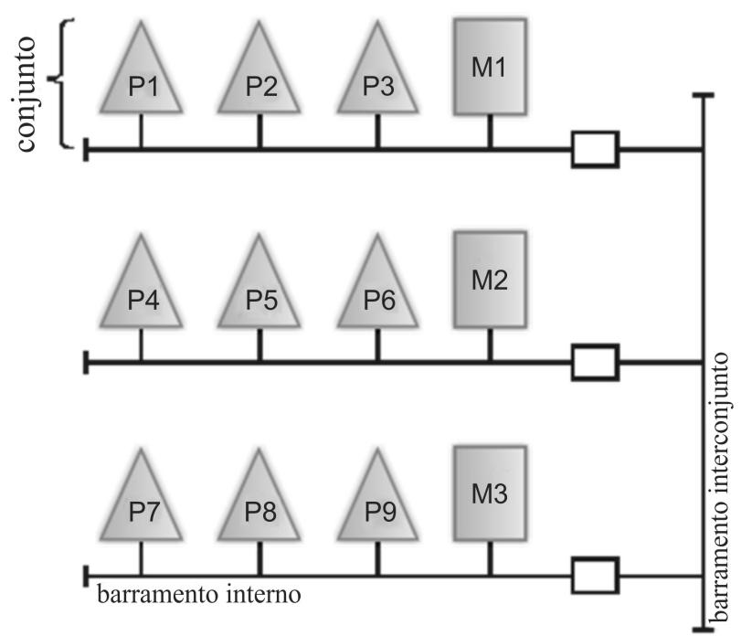
Com relação à figura acima, que ilustra um sistema com múltiplos processadores, na qual os símbolos triangulares, identificados de P1 a P9, representam processadores; os símbolos retangulares, identificados de M1 a M3, representam memórias; ao passo que as linhas que interligam esses conjuntos são barramentos, julgue o item a seguir.
