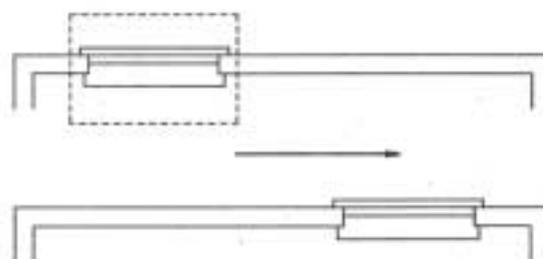
**110** As entidades de desenho podem ser movidas por meio dos seus pontos de controle. O deslocamento desses pontos pode ser gerado pelo movimento do cursor do mouse ou pela entrada de coordenadas polares na linha de comando.
