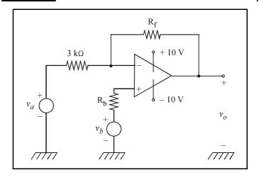
Considere que, no circuito elétrico representado acima, o amplificador operacional seja ideal e que o ajuste das tensões  $v_a$  e  $v_b$  das fontes de tensão sejam tais que a tensão de saída  $v_o$  situe-se na faixa de operação linear do amplificador operacional. Com base nessas informações, o valor da resistência  $R_p$  em k $\Omega$ , que permite um ajuste tal que a tensão  $v_o$  seja igual a  $3v_b$ - $2v_a$  é igual a
