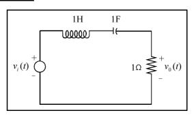
Considere o circuito elétrico mostrado na figura acima, com tensão de entrada e de saída  $v_i(t)$  e  $v_o(t)$  respecivamente. As transformadas de Laplace associadas a esses sinais são  $V_i(s)$  e  $V_0(s)$ , respectivamente. A relação, no domínio s, da tensão de saída e de entrada resulta na função de transferência de um filtro. A respeito da função de transferência relacionando  $V_0(s)$  e  $V_i(s)$ , assinale a opção correta.
