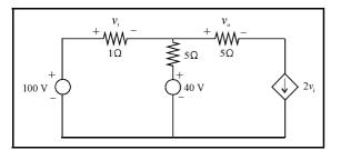
O circuito elétrico ilustrado acima, composto por resistores, duas fontes de tensão independentes e uma fonte de corrente controlada por tensão, representa o modelo de um dispositivo elétrico hipotético. Assinale a opção correta com relação à operação desse circuito elétrico e das grandezas nele indicadas.
