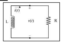
No circuito elétrico acima, são conhecidas as grandezas  $v(t) = 100e^{-25t}$ , em volts, e  $i(t) = 4e^{-25t}$ , em amperes, para instantes de tempo  $t \ge 0$ , em segundos. A respeito desse circuito elétrico e do seu funcionamento, assinale a opção **incorreta**.
