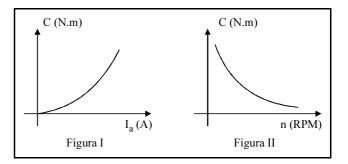
As figuras I e II acima mostram, respectivamente, as características conjugado *versus* corrente de armadura e conjugado *versus* velocidade angular obtidas a partir de ensaios em um motor de corrente contínua. Assinale a opção que corresponde ao provável tipo de motor submetido aos ensaios.
