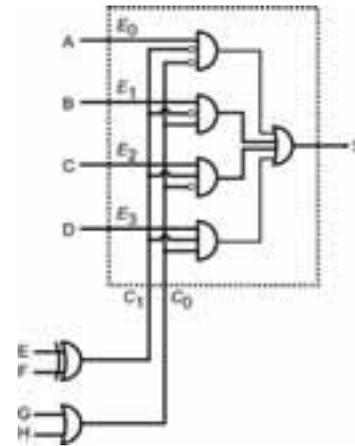
A figura acima mostra um circuito combinacional que utiliza um multiplexador de 4 para 1, com dois bits de controle  $C_0$  e  $C_1$ , 4 bits de entrada,  $E_3$ ,  $E_2$ ,  $E_1$  e  $E_0$ , e uma saída S. O circuito construído com base nesse multiplexador tem 8 entradas, A, B, C, D, E, F, G e H, e uma saída S que coincide com a saída do multiplexador. Com relação a esse circuito, julgue o item abaixo.
