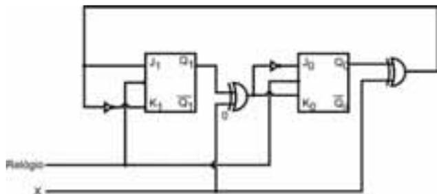
A figura acima mostra um circuito sequencial que usa *flip-flops* JK gatilhados por borda de descida, implementado com circuitos integrados com tecnologia TTL. Nesse circuito, o relógio é um sinal TTL compatível com os circuitos integrados usados e o sinal X é um sinal de controle TTL que pode ter valor lógico 0 ou 1. Com relação a esse circuito, julgue o item abaixo.
