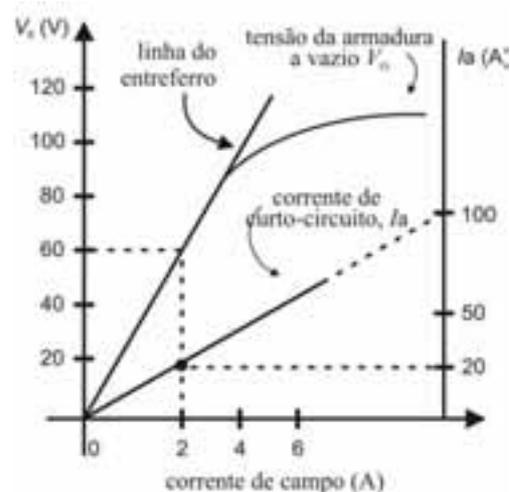
O gráfico na figura acima representa as características de tensão a vazio e de corrente de curto-circuito de um gerador trifásico. A grandeza  $V_0$  é a tensão fase-neutro a vazio nos terminais do gerador e  $I_a$  é a corrente na armadura quando os terminais do gerador são curto-circuitados. A resistência por fase no circuito da armadura é desprezível.
