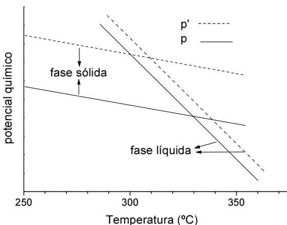
A figura acima corresponde ao diagrama do potencial químico *versus* temperatura, para a fase sólida e a fase líquida de determinada substância, em duas pressões distintas:  $p$  (linha cheia) e  $p'$  (linha pontilhada), em que  $p' > p$ . Com base nessas informações e no diagrama, julgue os itens subsequentes.
