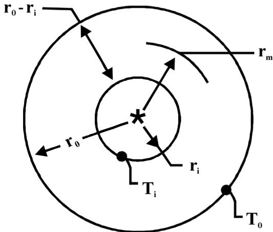
A figura acima ilustra um corte transversal em uma tubulação cilíndrica oca cujo diâmetro interno  $2r_i$  é igual a 40 mm e a espessura  $r_0 - r_i$  é igual a 20 mm. A superfície interna da tubulação tem temperatura  $T_i$ , enquanto a externa tem temperatura  $T_0$ . Com base nessas informações, julgue os seguintes itens.
