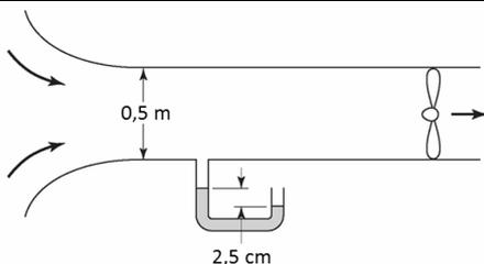
Suponha que um sistema de exaustão faça sucção de uma corrente de gás que escoar através de uma tubulação, como ilustrado no esquema da figura acima. No sistema, há um manômetro diferencial funcionando com pressão de vácuo de 2,5 cm de coluna de água. Tendo como base essas informações e considerando que a densidade do gás equivale a  $1,25 \text{ kg} \times \text{m}^{-3}$ , julgue os itens subsequentes.
