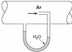
Considere que o fluxo de ar de densidade igual a  $1,20 \text{ kg} \times \text{m}^{-3}$  passe por uma tubulação com velocidade de  $20 \text{ m} \times \text{s}^{-1}$ , como ilustrado na figura acima. Considere, ainda, que a densidade da água seja igual a  $1.000 \text{ kg} \times \text{m}^{-3}$ . Com base nessas informações, julgue os próximos itens.
