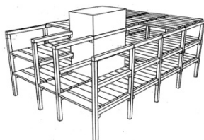
Figura II – esqueleto de pré-moldado de concreto, com uma torre fundida in loco no miolo
