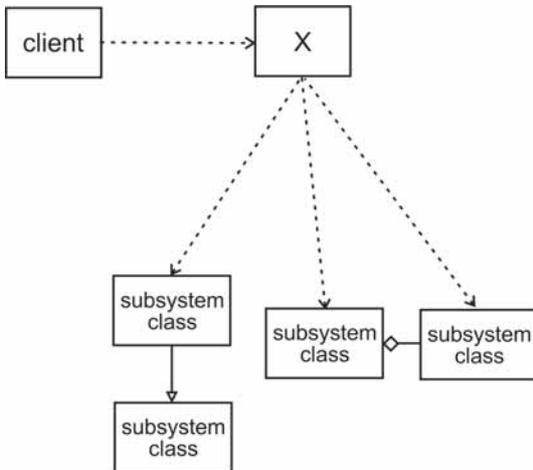
Considerando a arquitetura e padrões de projeto JEE, assinale a opção que apresenta o padrão de projeto que substitui corretamente o bloco indicado por X na figura acima, com vistas a fornecer uma interface unificada de nível mais alto para um conjunto de interfaces em um subsistema.
