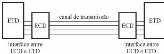
Considerando que, no sistema de comunicação de dados representado pelo diagrama de blocos, ETD representa o equipamento terminal de dados (computador, celular, *tablet* etc.) e ECD, o equipamento de comunicação de dados, assinale a opção correta.
