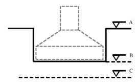
A figura acima ilustra uma cava de fundação para a execução de uma sapata retangular de concreto isolada, em que A corresponde ao nível do terreno natural, B corresponde à cota de assentamento e C, ao nível do lençol freático; o tracejado mais claro representa a posição da futura fundação. Com base nessas informações, julgue os itens que se seguem.
