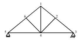
A figura acima representa uma tesoura de madeira, como parte da estrutura de um telhado onde as telhas não são fixadas na estrutura. Com base na figura, julgue os itens a seguir.
