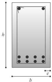
A figura acima ilustra a seção transversal de uma viga de concreto armado biapoiada, na qual o diâmetro dos estribos é igual a 5 mm e o diâmetro de todas as barras longitudinais é igual a 10 mm. Com base nessas informações e na figura, julgue os itens seguintes.
