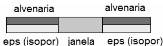
Ao se projetar uma instalação, é importante saber de que forma essa instalação reagirá ao calor produzido no ambiente. O coeficiente de transmissão térmica  $K$  relacionado a um determinado elemento da instalação, como uma de suas paredes ou uma janela, ou, então, à instalação toda é uma medida da quantidade de calor por unidade de tempo que atravessa uma superfície de área unitária por unidade de diferença de temperatura entre os ambientes que esse elemento separa.
