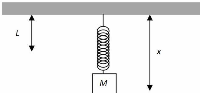
A figura acima ilustra uma mola, de alongação natural igual a  $L$ , presa no teto de um laboratório, e um objeto, de massa  $M$ , pendurado na ponta livre da mola. Na figura,  $x$  é a distância do objeto ao teto do laboratório.
