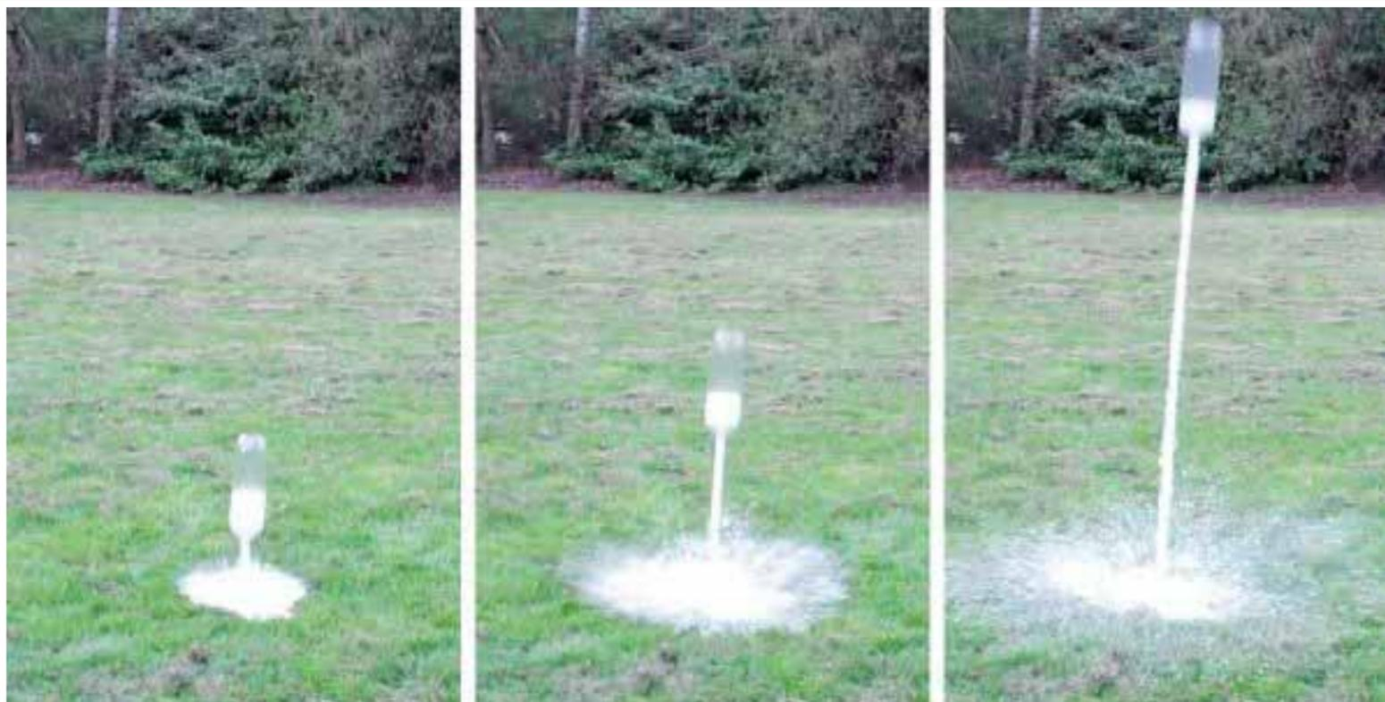
O vinagre que se vende nos supermercados e nas mercearias tem apenas 4,0%, em massa, de ácido acético. Os outros 96% são constituídos, basicamente, de água. Mesmo assim, reage violentamente com o bicarbonato de sódio, produzindo acetato de sódio, gás carbônico e água. A expansão do gás gerado pode ser utilizada para a construção de foguetes de brinquedo, como ilustra a sequência de fotos acima.
