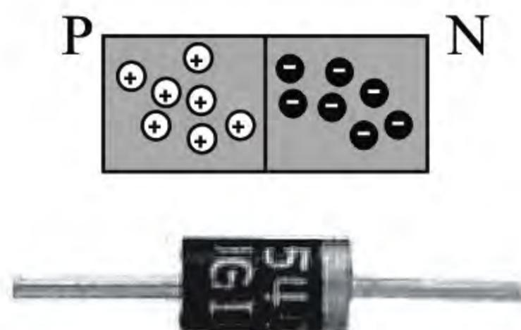
O diodo semicondutor é um componente eletrônico que tem duas polaridades: anodo (terminal positivo) e catodo (terminal negativo), formando uma junção  $p-n$ , como ilustrado na figura acima. O diodo semicondutor é chamado retificador, pois permite a passagem de corrente elétrica apenas quando está conectado no circuito na forma denominada direta; ou, de maneira mais simplificada, funciona como se fosse uma válvula que só deixa a corrente passar pelo circuito em um sentido.
